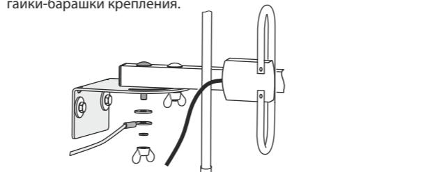
6.11 Зафиксируйте антенный кабель хомутом на кронштейне. Кабель должен иметь плавный изгиб от вилки SMA до места фиксации.
