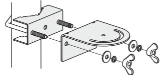
6.4 Закрепите антенну на кронштейне. Используйте Винты M5 с квадратными подголовниками. Перед тем как накрутить гайки-барашки установите обычные и стопорные шайбы.
