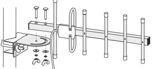
6.5 Просверлите отверстие диаметром 10мм в том месте, где антенный кабель должен попасть в помещение. Протащите кабель через отверстие. Минимальный радиус изгиба 50мм. При недостаточной длине основного кабеля используйте антенный удлинитель 5м.
