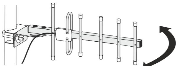
6.10 Подключите провод заземления к антенне. Затяните гайки-барашки крепления.
